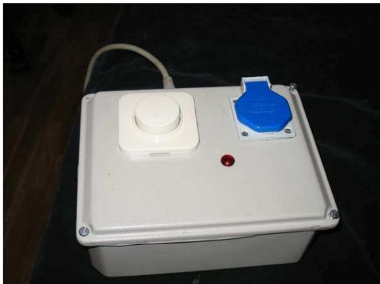
En la tapa está el regulador, un piloto y una toma de corriente -enchufe, para entendernos, que está conectado al regulador para obtener una tensión de 0 a 220 voltios (aún que esto presenta algunas pegas que explicaré más adelante). A este enchufe se puede conectar luego alguna luz del belén que queramos ajustar en luminosidad, por lo que la caja no sólo nos sirve para construir el belén, además la podemos utilizar en la instalación del belén. Optimizar recursos, que se dice.
