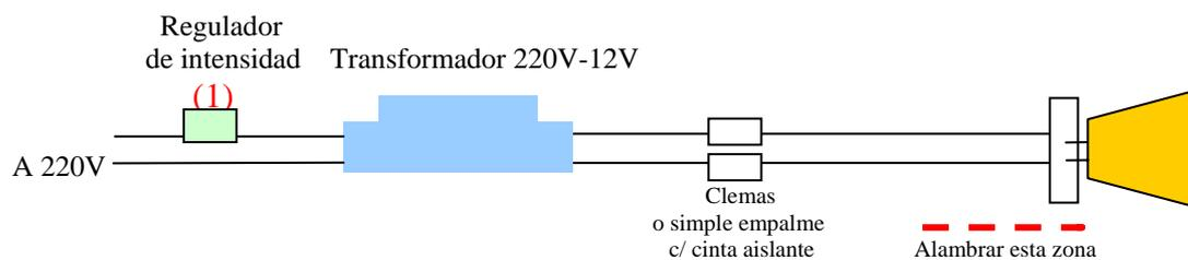
(1) Se recomienda que el regulador se coloque en un sitio realmente accesible durante el funcionamiento del Belén. Debajo de la mesa, cercano al borde del Belén bajo un corcho...etc.
