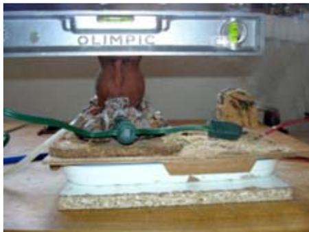
Por lo que colocaremos la placa base con el depósito de líquido fumígeno solamente, y lo nivelaremos, usando un nivel de burbuja aplicado al borde superior del depósito.
